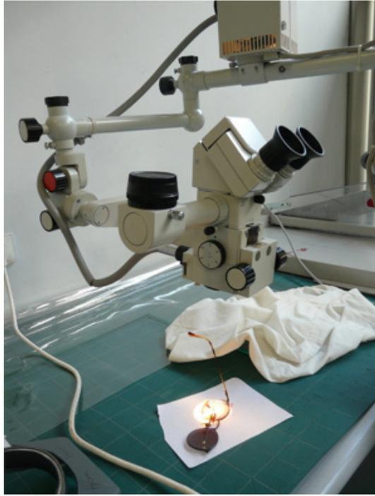
**Illustration 4 :** Observation sous loupe binoculaire de la dégradation d'une paire de lunettes en acétate de cellulose
